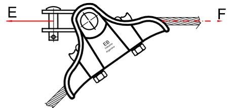
Carga de deslizamiento del conductor en la grapa -
